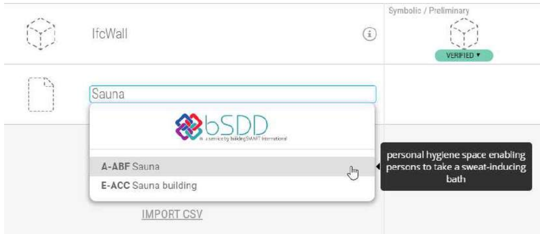
Figura 3.61: Interfaccia utente di Plannerly permette di navigare il contenuto del bSDD durante la fase di creazione di IDS
